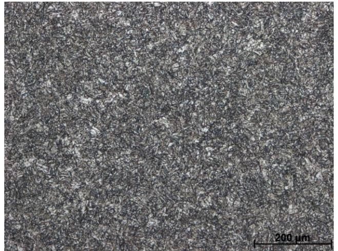
Aço inoxidável endurecível por precipitação N4534® após solubilização a 925°C por 1h30min com têmpera em água + sub-zero.
